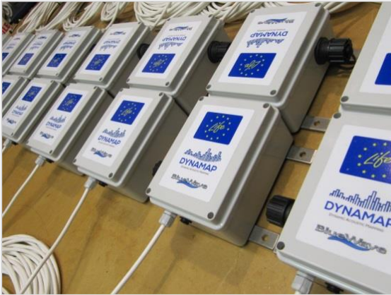
Figura 2 – Dispositivi di monitoraggio acustico realizzati per il sito di Roma.
